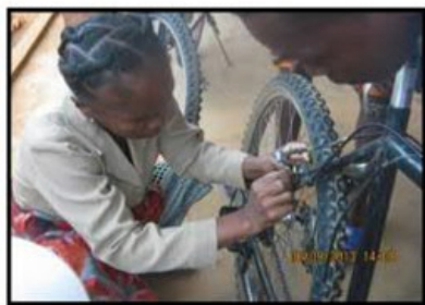
Entretien et réparation du frein (remplacement du patin)
